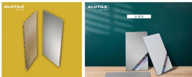
“全维板”源于其内芯结构特殊技术“窝壳状全维桥拱结构金属板材”缩写。该板材的铝内芯层经特殊辊模压延，在形成双面凸点过程中，点与点之间在应力作用下，使卷铝金属薄片形成半窝壳状连续性桥拱结构的中间层芯材，经上、底铝卷材复合而成全维度（无方向）均匀受力的铝板。
