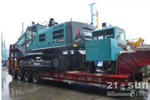
SWE600FRC 智能遥控挖掘机在“矿山猛士”SWE600F 挖掘机的基础上，增配遥控系统，具备近程遥控器操作、远程遥控舱操作多种作业模式，灵活应用于矿山施工作业多种场景。值得一提的是，为满足远程全方位施工监控，SWE600FRC 智能遥控挖掘机还采用超远距离无线传输系统，延时低，传输距离远，最远传输距离可达 3km。
