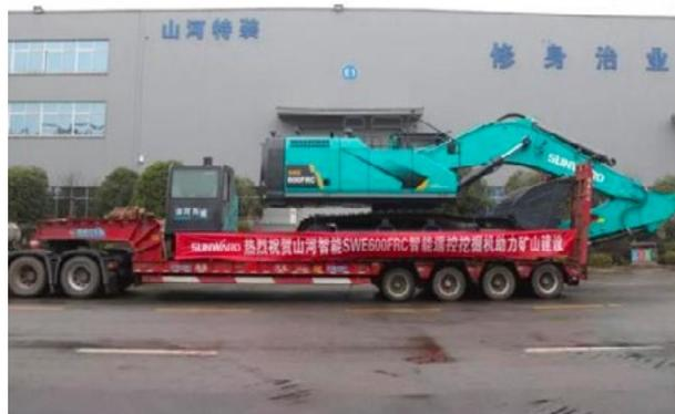
本次发往内蒙古某矿山的山河智能首款大吨位用于矿山的遥控挖掘机，以智能化技术为导向打造，能够实现多模式高临场感遥操作，可有效解决传统矿山施工中的塌方、烟尘、有害气体及人员高强度作业等“痛点”问题。
